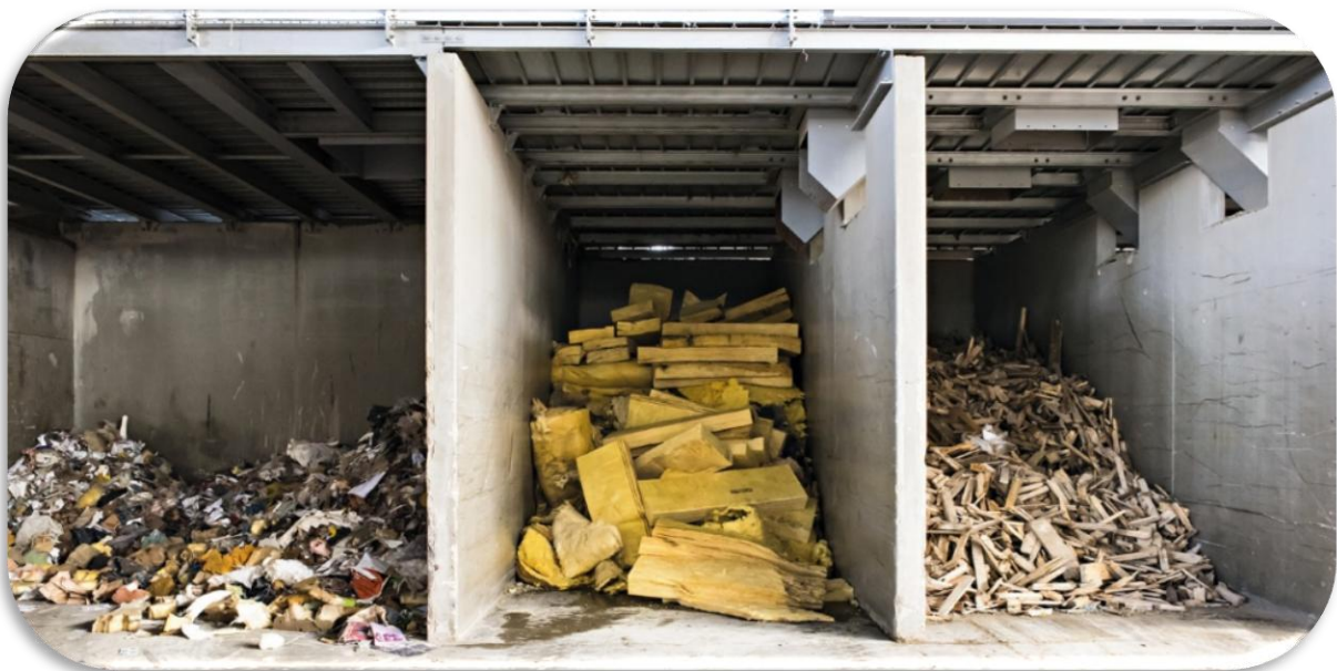
Imagen 1: Segregación de materiales para la reutilización y reciclaje. Saint-Gobain
